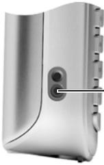
Nach Entfernen der Kunststoffabdeckung können Sie ein Headset mit 2,5 mm Klinenstecker an der linken Seite Ihres Mobilteils anschließen.
