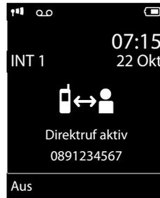
Beim Drücken einer beliebigen Taste wird die gespeicherte Nummer gewählt. Drücken Sie die Auflegen-Taste
